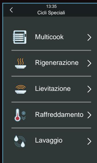
**cicli speciali multicook** con funzione count-up che permette un ciclo di cottura "continua" e funzione count-down in cui teglie con tempi di preparazione differenti completano la cottura tutte nello stesso momento
